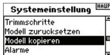
Drehen Sie den Roll Druck Taster bis zu dem Menü Modell kopieren und wählen es durch drücken aus:
