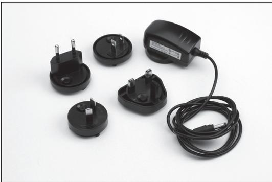
Stecken Sie das Netzgerät in eine Steckdose und stecken das Ladekabel in die Ladebuchse des ausgeschalteten Senders. Die blaue LED auf der Vorderseite leuchtet. Wenn Sie den Akku gegen den SPMB4000LPTX Lipo Akku tauschen, dauert es ca. 30h bis dieser geladen ist, abhängig vom ausgehenden Ladestand. Ist der Lipo Akku voll, erlischt die blaue LED. Lassen sie das Netzteil oder Akkus nie fallen.
