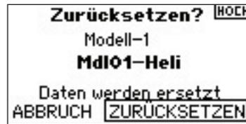
Stellen Sie sicher, dass das Modell das Sie löschen möchten auch auf dem Display angezeigt wird. Falls nicht, sehen Sie bitte auf Seite 12 des Manuals nach. Wählen Sie durch drehen das gewünschte Modell aus und wählen dann im Display Zurücksetzen bestätigen.
