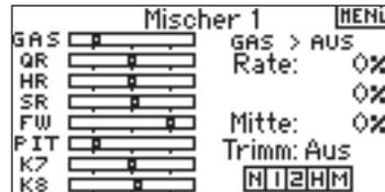
Drehen Sie den Roll Druck Taster auf das rechte deaktiviert Feld. Drehen Sie den Rolltaster um den Slavekanal einzustellen. Haben Sie den Slave Kanal gewählt, drücken Sie den Roll Druck Taster um ihn zu bestätigen.
