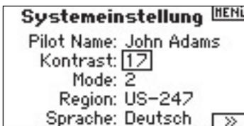
Wählen Sie einen Wert von 1 -20 bis Ihnen der Kontrast zusagt. Drücken Sie den Roll Druck Taster zur Bestätigung.
