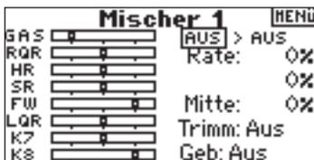
Drehen Sie den Roll Druck Taster auf das rechte deaktiviert Feld. Drehen Sie den Rolltaster um den Slavekanal einzustellen. Haben Sie den Slave Kanal gewählt, drücken Sie den Roll Druck Taster um ihn zu bestätigen.
