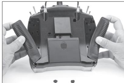
Schritt 2. Sind Sie mit der Steuerkraft zufrieden, stecken Sie die Gummipolster wieder auf.
