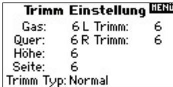
Wähle Sie durch Drehen den gewünschten Kanal. Drücken Sie den Roll Druck Taster und stellen den gewünschten Wert durch Drehen ein. Wiederholen Sie dieses wenn gewünscht für alle Kanäle.
