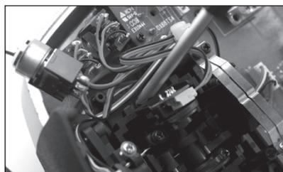
Schritt 8. Montieren Sie die Rahmen fur die Steuerknuppel sowie die beiden Platinen und dann das ruckwertige Gehause des Senders. Stellen Sie sicher, dass Sie keine Kabel oder die Gummigriffe quetschen. Ziehen Sie die 6 Gehause­schrauben an. Montieren Sie jetzt alle Gummigriffe.
