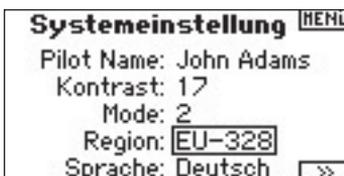
Drehen Sie den Roll DruckTaster um die Region auszuwählen in der der Sender betrieben wird. Wählen Sie die Region durch drücken aus.
