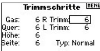
Drehen Sie den Roll Druck Taster auf Trimm Typ und wählen ihre Auswahl auf Flugzustand/Flight Mode oder Normal.
