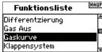
Wählen Sie durch drehen Gaskurve und drücken dann den Taster.
