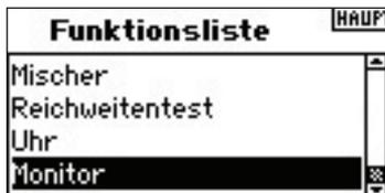
Drehen Sie den Roll Druck Schalter auf Monitor und drücken ihn dann.
