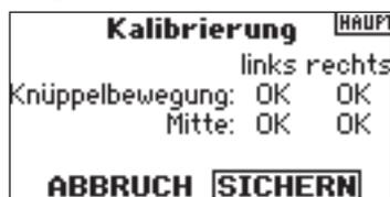
Um zu kalibrieren, bewegen Sie die Knuppel uber den gesamten Weg von einer Endstellung in die andere und dann zuruck in die Mittelsteckung. Stehen alle Knuppel in der Mittelstellung, drucken Sie sichern, um die Einstellung zu speichern.
