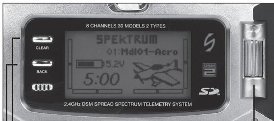
Mit Drücken der Roll Druck Taste navigieren Sie zu den Menü und Funktionen.
