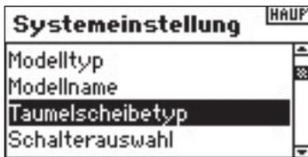
Drehen Sie den Roll Druck Taster bis Taumelscheibentyp hinterlegt ist. Wählen Sie ihn durch drücken aus.
