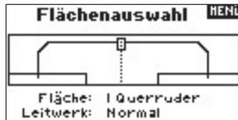
Drehen Sie den Roll Druck Taster bis ihr Flächentyp hinterlegt ist. Wählen Sie ihn durch Drücken aus.
