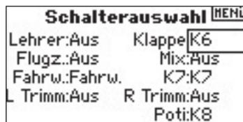
Drehen Sie den Roll Druck Taster bis der gewünschte Kanal mit dem der Schalter belegt werden soll hinterlegt ist. Wählen Sie ihn durch Drücken aus. Wiederholen Sie diesen Vorgang für alle gewünschten Schalter.
