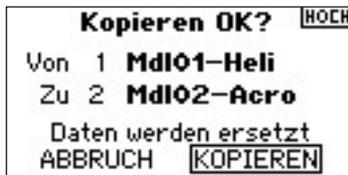
Wählen Sie durch drehen Kopieren und bestätigen dieses durch drücken wenn Sie das Modell kopieren möchten. Nach dem Kopieren wird wieder das Hauptdisplay angezeigt.
