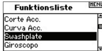
Wählen Sie durch drehen und drücken des Roll Druck Taster den Programmpunkt Taumelscheibe aus.
