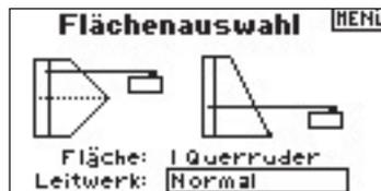
Drehen Sie den Roll Druck Taster bis ihr Leitwerkstyp hinterlegt ist. Wählen Sie ihn durch Drücken aus.
