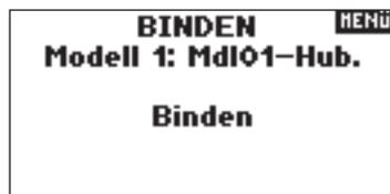
4. Das Display zeigt Ihnen den Speicherplatz an. Nach einigen Sekunden wird sich das System verbinden und wechselt in das Hauptdisplay.
