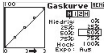
Ändern Sie den Wert durch drehen. Bitte beachten Sie die Position der Kurve auf der linken Seite des Displays.
