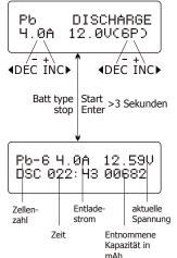
Stellen Sie links den Entladestrom ein und rechts die Nennspannung, **nicht die Entladeschlussspannung.**
