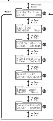
B0: Lithium "Vorladung": Dauer mit der Lithium Akkus ungeachtet Ihrer Spannungslage geladen werden bis die Unterspannungsüberwachung greift. Wir empfehlen die Deaktivierung dieser Funktion. Wird ein Lithium Akku mit Unterspannung zu lange geladen, ohne dass dieser Spannung annimmt, kann es zur Explosion kommen.
