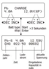
Stellen Sie links den Ladestrom ein und rechts die Spannung.
