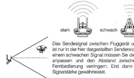
Das Sendesignal zwischen Fluggerät und Fernbedienung ist nur in der hier dargestellten Sendereichweite optimal. Bei einem schwachen Signal müssen Sie die Antennenposition anpassen und den Abstand zwischen Fluggerät und Fernbedienung verringern. Erst dann ist eine optimale Signalstärke gewährleistet.
